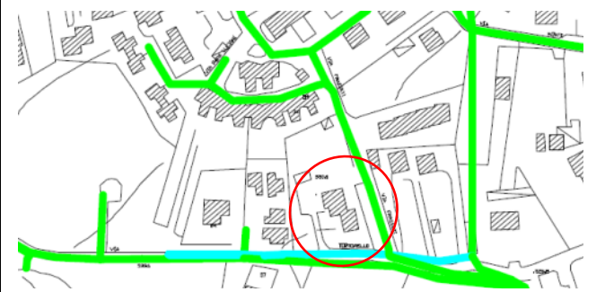
Scheda C1 - Via Via Tortorello: Fognatura mista e bianca (estratto) Grafo SMAT 2018 aggiornato 2023 Uff. Tecnico Comunale
