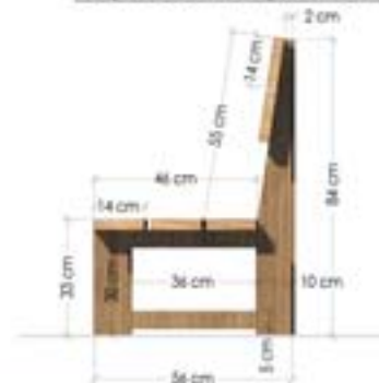
Prospetto laterale e pianta della panchina
