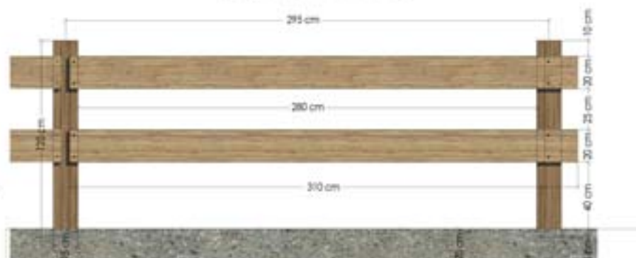
Prospetto della staccionata
