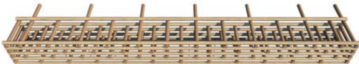
Vista asonometrica dello schema di composizione della palificata doppia
