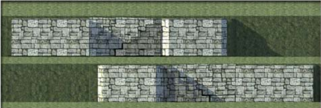
Tipologia di muro a secco con gradini in nicchia
