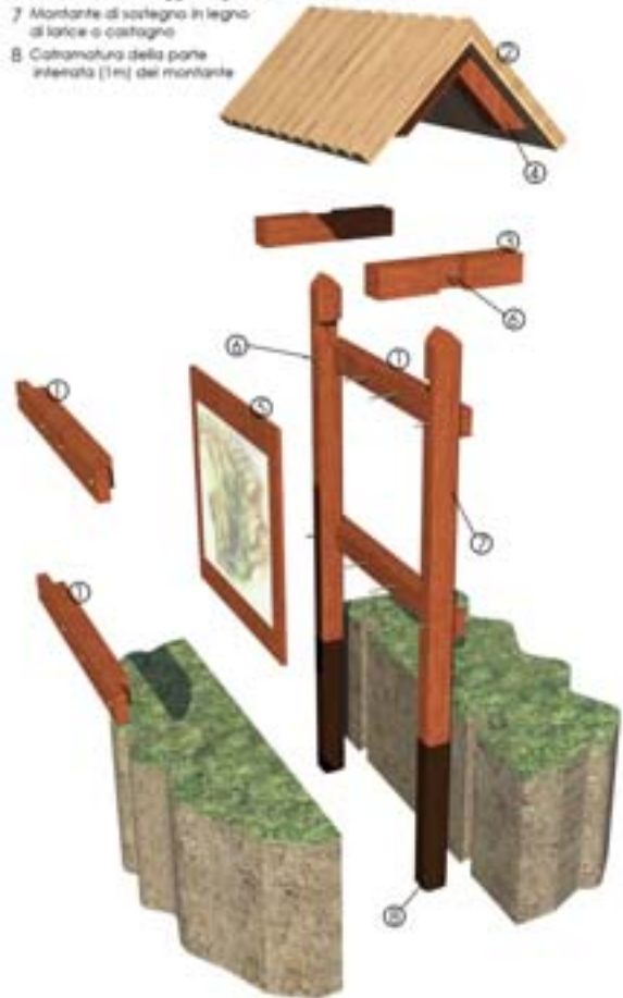
Sezione longitudinale prospettica della bacheca
