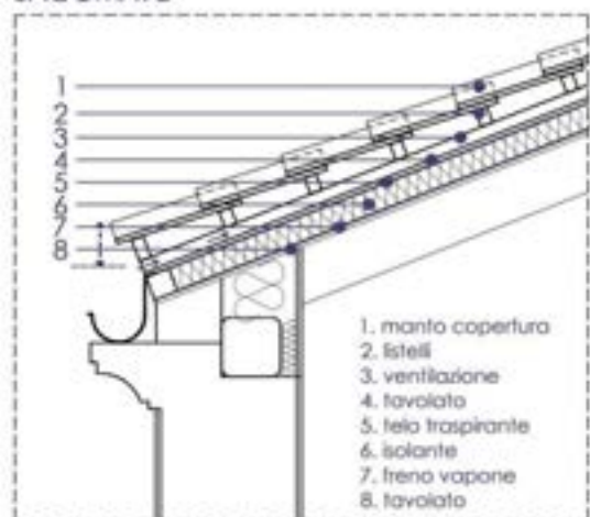
COPERTURA ISOLATA CON CORNICIONE SAGOMATO
