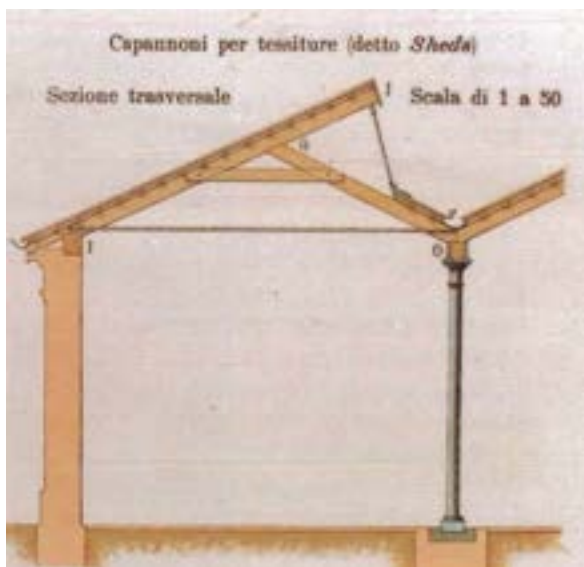
Esempio di copertura in Sheds con struttura lignea e colonne in ghisa
